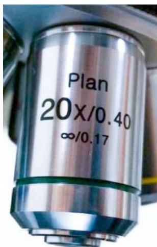
На Рис.1 представлен планахроматический объектив с увеличением 20 крат, числовой апертурой 0.40, коррекцией на бесконечную длину тубуса и толщину покровного стекла 0.17 мм
