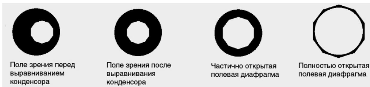
Рис.14. Настройка освещения по Кёлеру.
