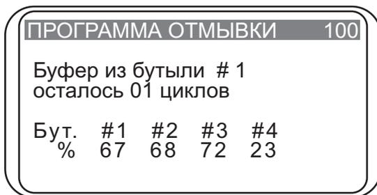
Рис. 7. Сообщения при работе программы с терминалом контроля объема жидкости
